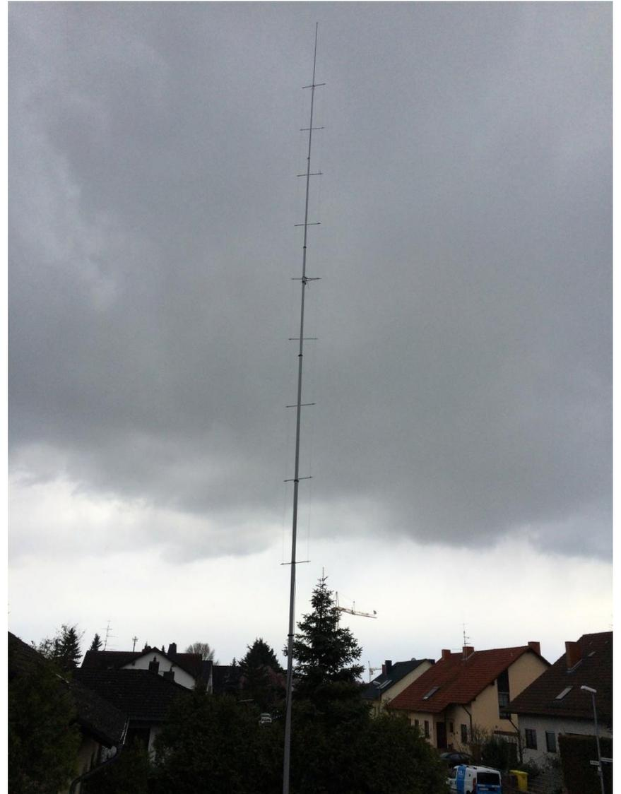
Am Ostersonntag (4.4.2015) war die Inbetriebnahme der Antenne. Auf Anhieb lag die Resonanzfrequenz innerhalb des 2m-Bandes (gemessen mit RigExpert AA600).
